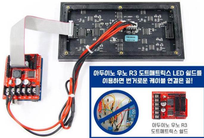
<그림 1-4> 도트매트릭스 LED 쉴드를 사용하여 연결된 사진
