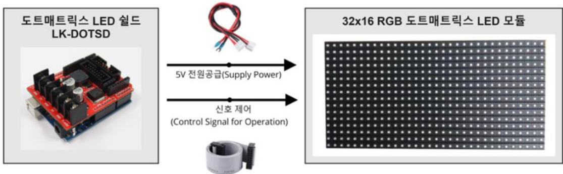
<그림 1-5> 32x16 도트매트릭스 RGB LED 모듈과 도트매트릭스 LED 쉴드의 연결 다이어그램
